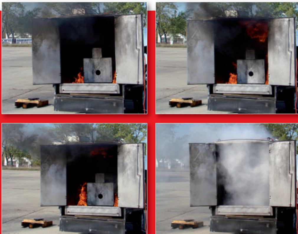
Mobil gyakorlati bemutató egy busz motorterét szimuláló eszközön. Sikeres tűzoltás. A +870 °C-os hőmérséklet 10 másodperc múlva +136 °C-ra csökkent
